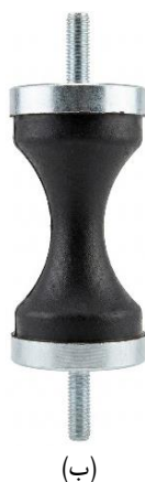
شکل ۳ نمونه دمبلی سه‌بعدی آزمون عمر خستگی، (الف) ابعاد و (ب) هندسه
