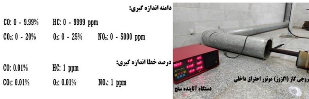
شکل ۶ تصویری از دستگاه آلاینده‌سنج در آزمایشگاه آزمون موتور دانشکده مهندسی مکانیک دانشگاه سمنان
