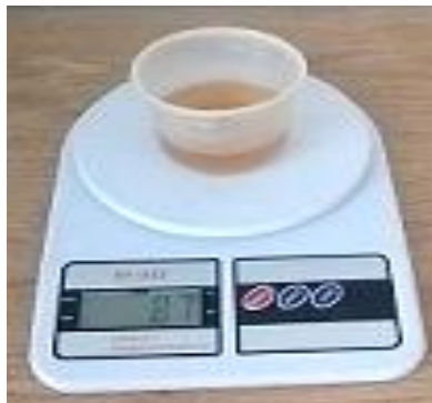
شکل ۹ اندازه‌گیری جرم گازوئیل پاشش شده توسط ترازوی عددی
