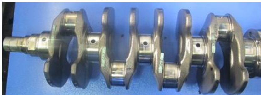
شکل ۱ بررسی یاتاقان‌های میل لنگ بعد از آزمون دوام تشدید
