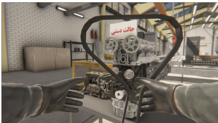
شکل ۶ نمایی از همبندی تسمه زمان‌بندی در حالت دستی
