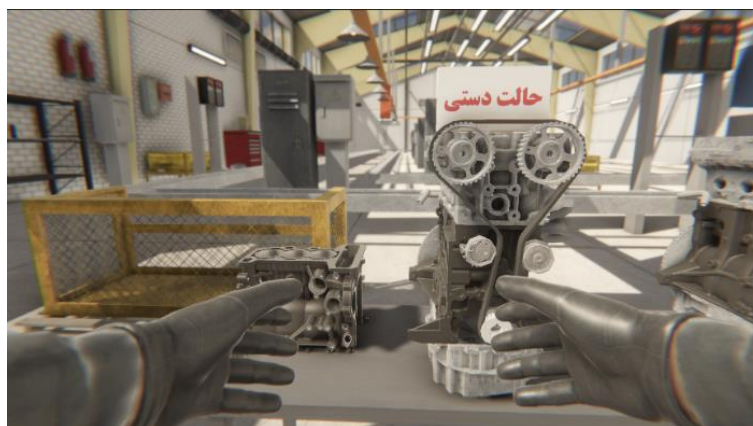
شکل ۸ نمایی از قرارگیری تسمه زمان‌بندی در محل نصب بر روی پایه حالت دستی
