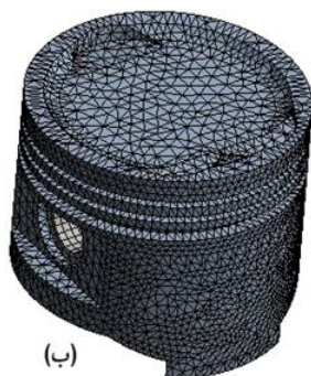
شکل ۱ الف) سمبه و پین سمبه و ب) مدل اجزای محدود سمبه و پین سمبه
