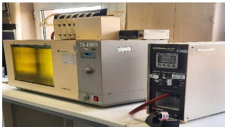
شکل ۶ دستگاه گرانروی‌سنج مورد استفاده به‌منظور اندازه‌گیری گرانروی نانوروانکار ترکیبی مورد تحلیل در این مطالعه
