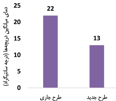
شکل ۷ تغییرات دمای میانگین دریچه‌های خروجی اتاق داخل خودروی تارا در چرخه‌ی رانندگی شهری
