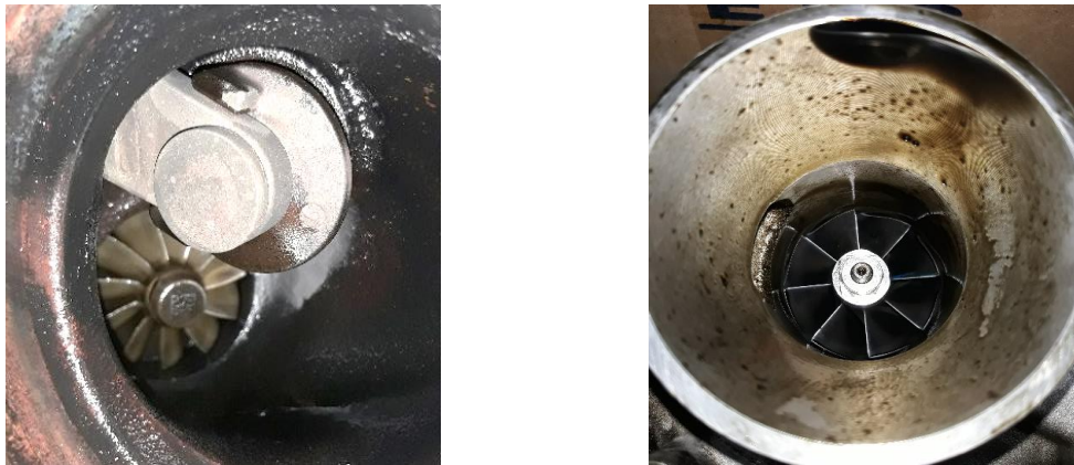
شکل ۱ ورود روغن به گردا و تنجار به دلیل خرابی آب‌بندها [۲]
