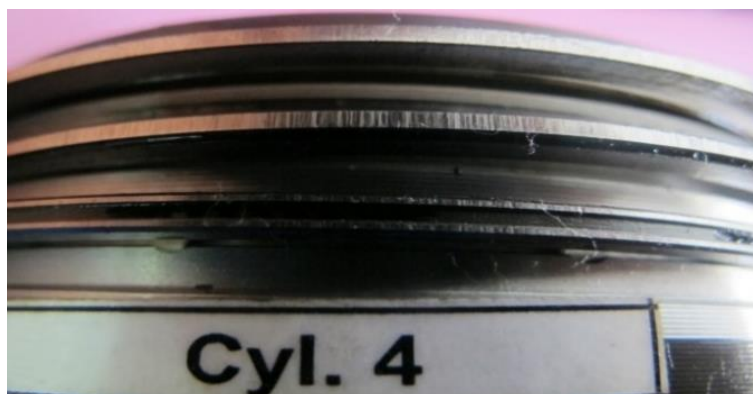
شکل ۴ حلقه‌های موتور شماره ۹، نتیجه درجه‌بندی: ۴
