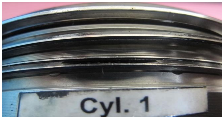
شکل ۳ حلقه‌های موتور شماره ۳، نتیجه درجه‌بندی: ۲
