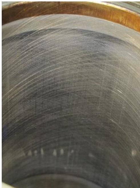
شکل ۲ سمت فشاری استوانه موتور شماره ۱۰، نتیجه درجه‌بندی: ۱
