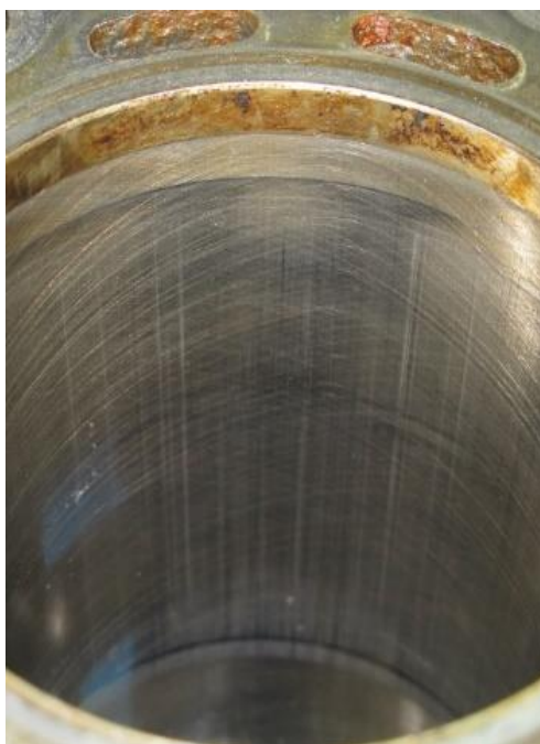
شکل ۱ سمت فشاری استوانه موتور شماره ۹، نتیجه درجه‌بندی: ۳
