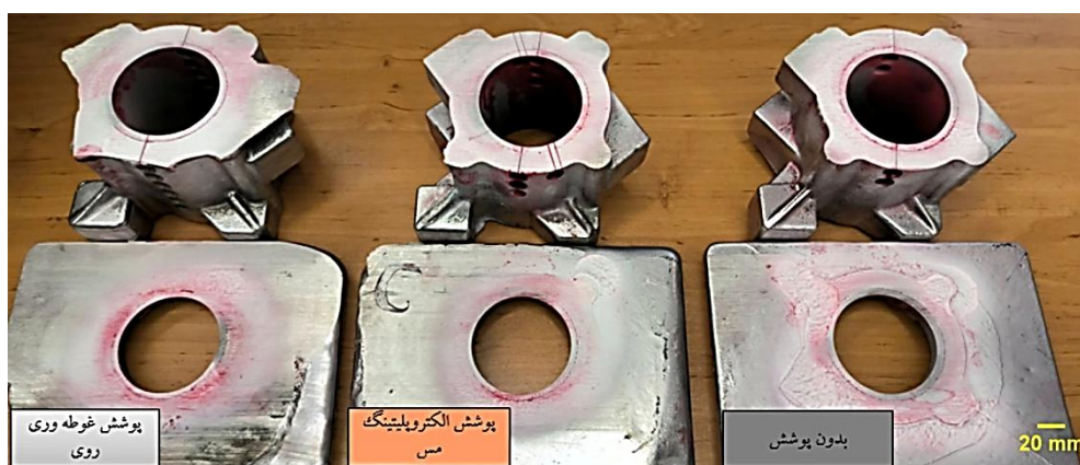
شکل ۲۱ آزمون غیر مخرب مایع نافذ بر روی سطوح نمونه‌های بدون پوشش، همراه با پوشش مس و همراه با پوشش روی
