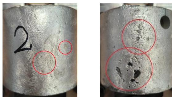
شکل ۱۸ نتایج پیش‌بینی عیوب ریخته‌گری در قطعه واقعی ریخته‌گری شده با قالب ساده‌سازی شده و دمای پیش گرم ۲۵۰ درجه سانتی‌گراد
