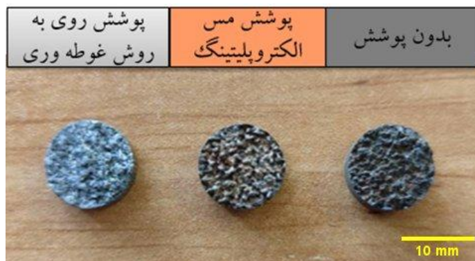
شکل ۲۰ پوشش باقیمانده در قسمت چدنی نمونه‌ها پس از ریخته‌گری آلومینیوم و جدا کردن قسمت چدنی از آلومینیومی
