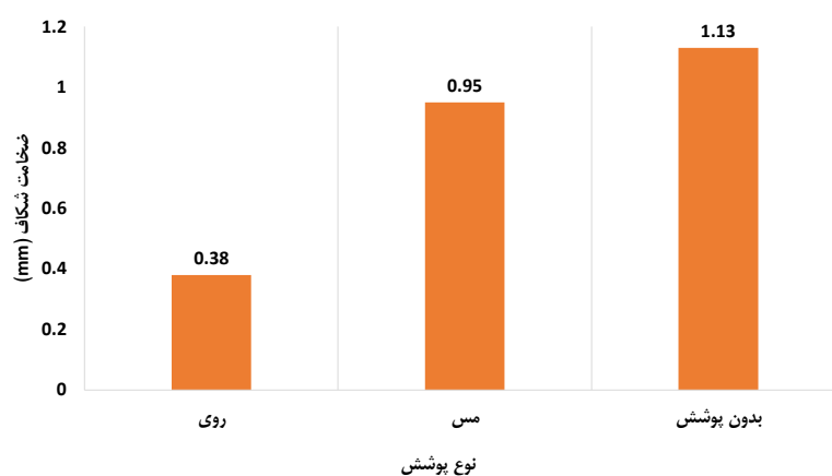
شکل ۲۳ نمودار بررسی میانگین ضخامت شکاف‌های آزمون مایع نافذ در نمونه‌های ریخته‌گری
