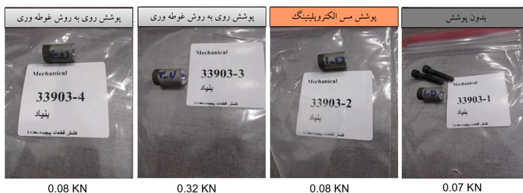
شکل ۲۴ نتایج نمونه‌های کشش قطعات با شرایط مختلف بدون پوشش، با پوشش مس و پوشش روی
