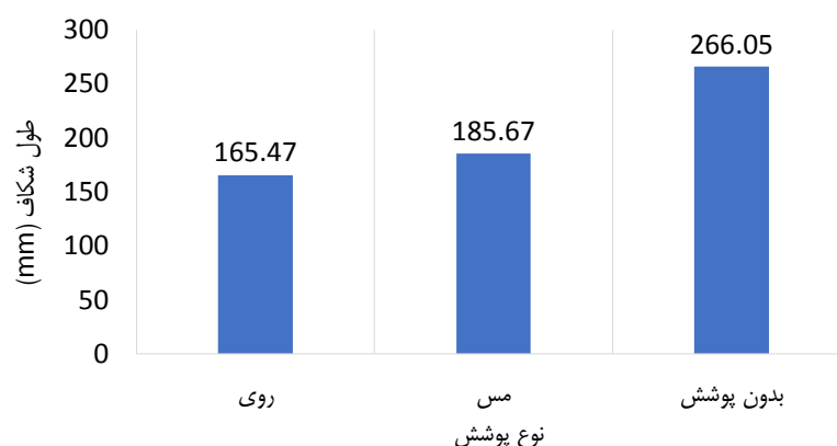
شکل ۲۲ نمودار بررسی مجموع طول شکاف‌ها در نمونه‌های تحت آزمون مایع نافذ
