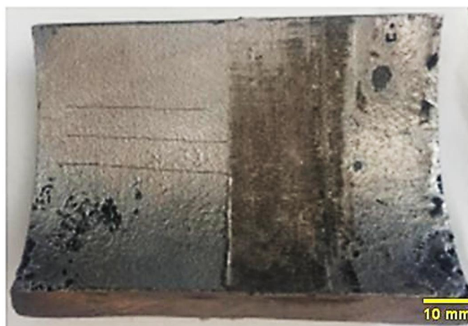
شکل ۱۹ نتیجه آزمون برش چاقوئی انجام شده بر روی نمونه پوشش داده شده به روش غوطه‌وری
