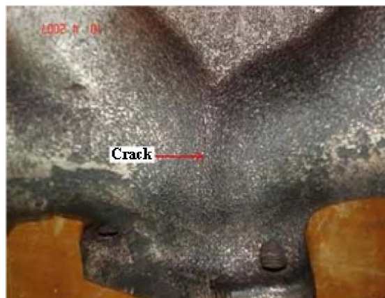
شکل ۱۳ چندراههٔ دود گسیخته شده در ناحیهٔ هم‌ریختگاه در آزمون ضربهٔ حرارتی [۳۰]
