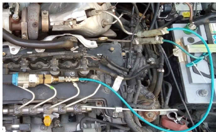
شکل ۳ حسگر فشارسنج بر روی موتور
