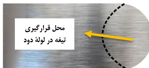
شکل ۸ تیغه فلزی به منظور شبیه سازی گرفتگی کامل صافی دوده.
