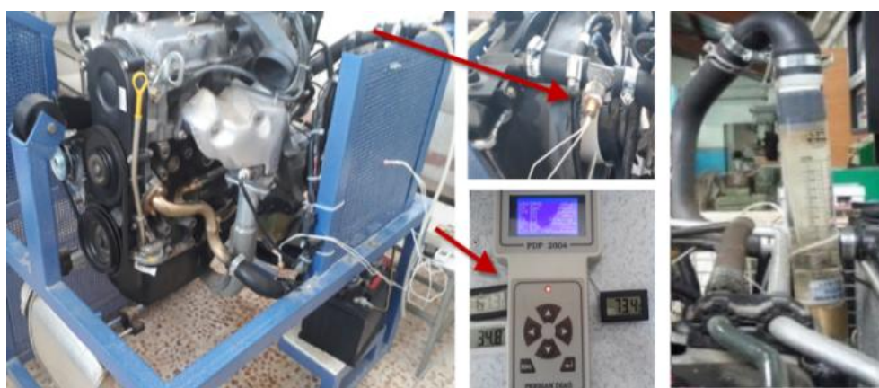
شکل ۷ محل نصب سنسورها بر روی موتور مورد آزمایش
