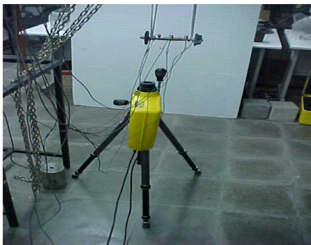
شکل ۵ آزمون ارتعاش‌سنجی محیطی محور دوار در حالت آزاد
