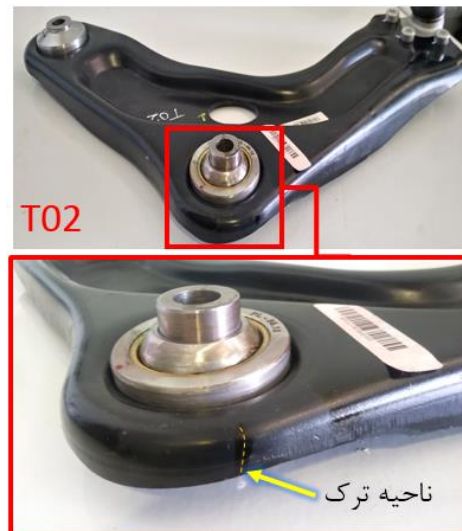
شکل ۱۰: ناحیه شکست در قطعه T02
