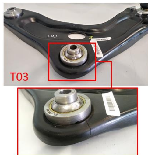
شکل ۱۱: ناحیه شکست در قطعه T03
