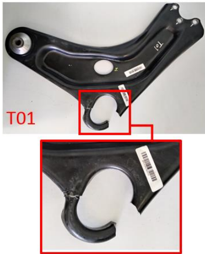
شکل ۹: ناحیه شکست در قطعه T01
