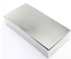
شکل ۲: آهنربا نئودیمی مورد استفاده در این پژوهش
