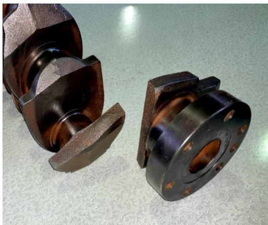
شکل ۱۸: نمونه‌ای از شکست یک میل‌لنگ ناشی از خستگی
