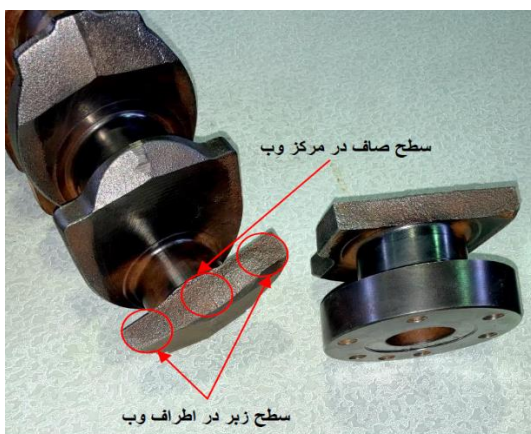
شکل ۱۹: نواحی صاف و زبر در شکست خستگی
