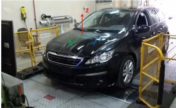
شکل ۱۱: خودروی مجهز به موتور سه استوانه‌ای خطی در اتاق آزمون
