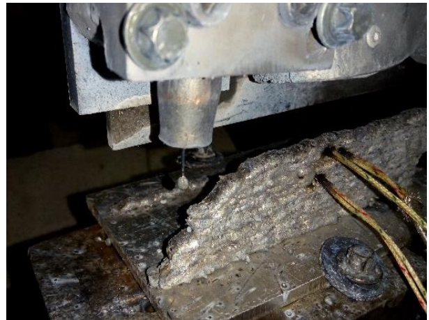
شکل ۱۱: قطره مذاب منجمد شده در حالت انتقال ترکیبی GL/SC
