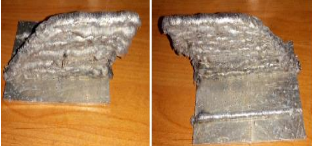
شکل ۱۵: ایجاد پدیده سرریز شدن مذاب در نمونه N7
