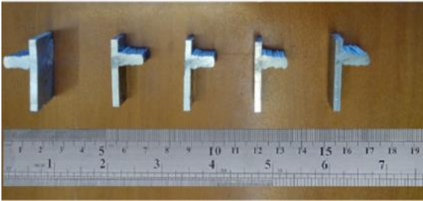
شکل ۹: مقاطع برش خورده رسوب گذاری خودکار پس از اصلاح محفظه گاز
