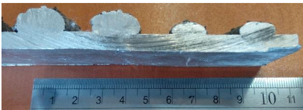
شکل ۶: حذف تخلخل های هیدروژنی موجود در نزدیکی سطح، در اثر تداوم گاز محافظ پس از رسوب گذاری
