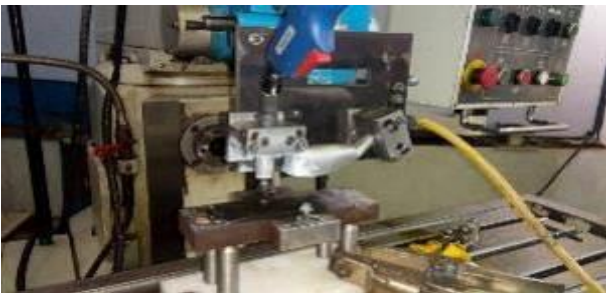
شکل ۷: تجهیزات هدایت و توزیع گاز محافظ اضافی
