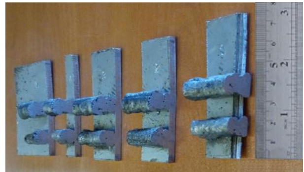
شکل ۸: مقاطع برش خورده رسوب گذاری خودکار با اضافه شدن تجهیزات هدایت گاز محافظ اضافی حین و پس از رسوب گذاری
