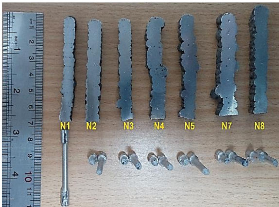
شکل ۱۷: مقاطع دیواره‌ها و نمونه‌های آزمون کشش N1 تا N8
