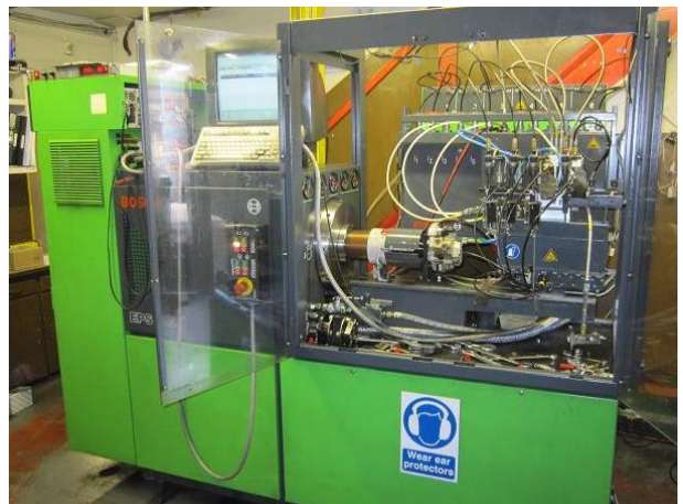
شکل ۳: دستگاه آزمون افشانه لوله مشترک
