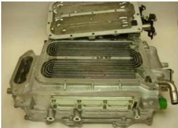
شکل ۴: نمونه موتور برقی مورد پژوهش و سامانه خنک کاری [۱۶]
