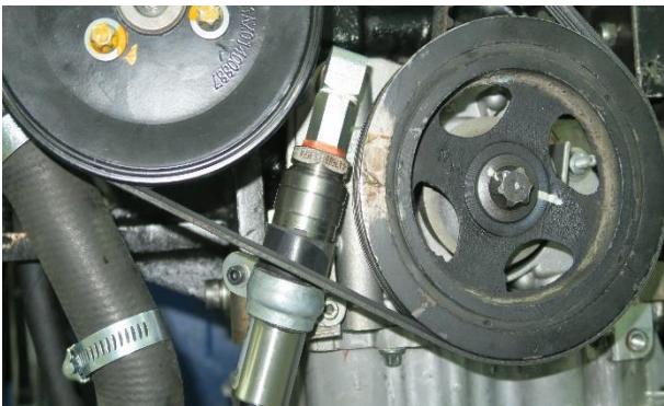
شکل ۵: نصب حسگر فشار بعد از خروجی تلمبه روغن
