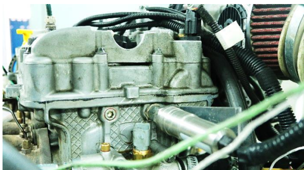
شکل ۶: نصب حسگر فشار سنج بر روی بستار
