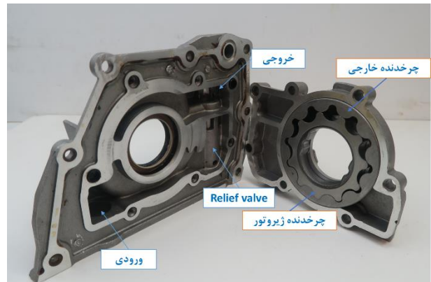
شکل ۳: نمای داخلی از تلمبه روغن مورد بررسی
