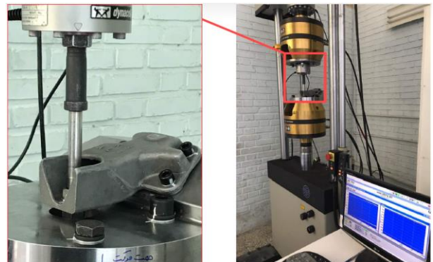
شکل ۲: ثابت کننده و پایه دسته موتور نصب شده بر روی دستگاه اینسترون
