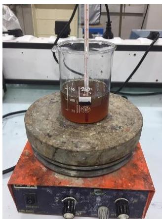
شکل ۵: آماده‌سازی نمونه نانوسیال
