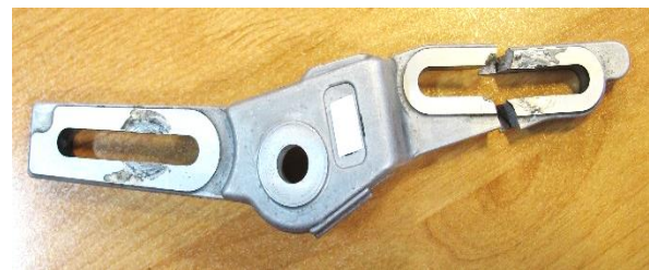
شکل ۵: محل شکست پایه تسمه سفت‌کن در آزمون شتاب یافته
