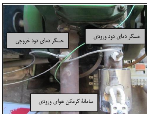
شکل ۱: سامانه گرمکن هوای ورودی و حسگرها
