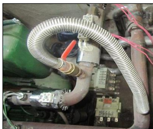
شکل ۲: سامانه بازخورانی گازهای برگشتی
