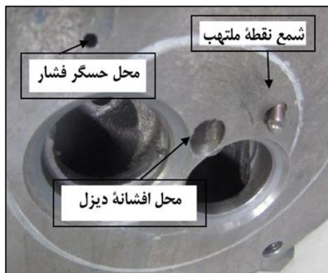
شکل ۳: استفاده از شمع نقطه ملتهب درون محفظه احتراق
