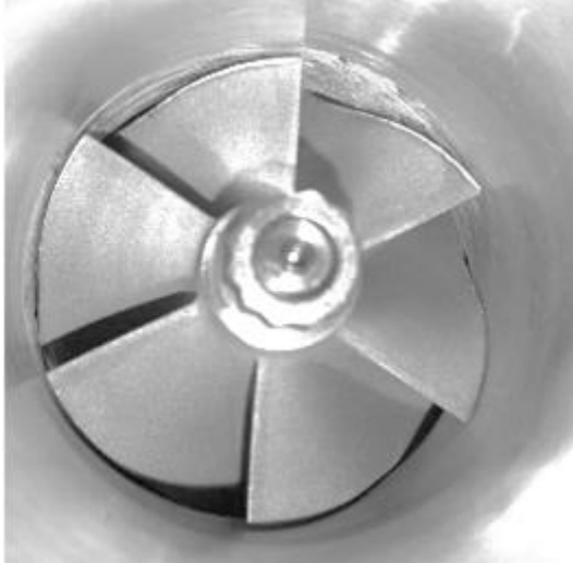
شکل ۱۵: آثار برخورد پروانه تنجار با محفظه
