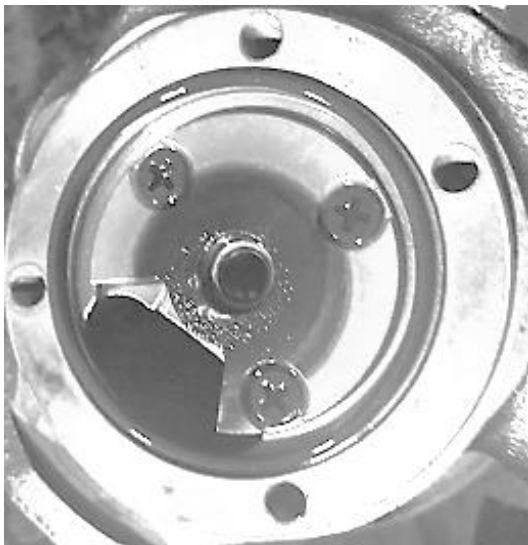
شکل ۱۶: آثار داغی مشاهده شده بر سطح بیرونی یاتاقان محوری
