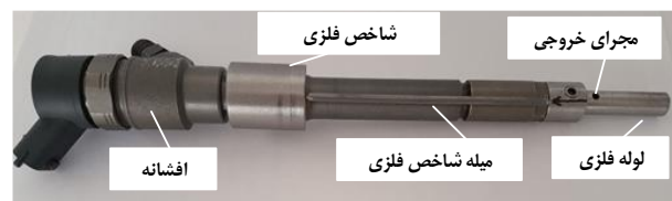
شکل ۳: افشانه دیزل
