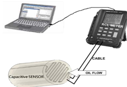
شکل ۳: طرح شماتیک آزمایش حسگر کیفیت روغن خازنی
