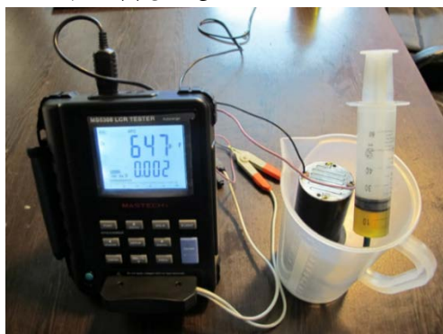
شکل ۵: تزریق روغن به حسگر خازنی و خوانش ظرفیت خازن توسط RCL METER
