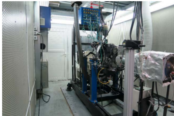
شکل ۶: نمایی از آزمون دوام موتور TU5 در اتاق آزمون دینامومتری
