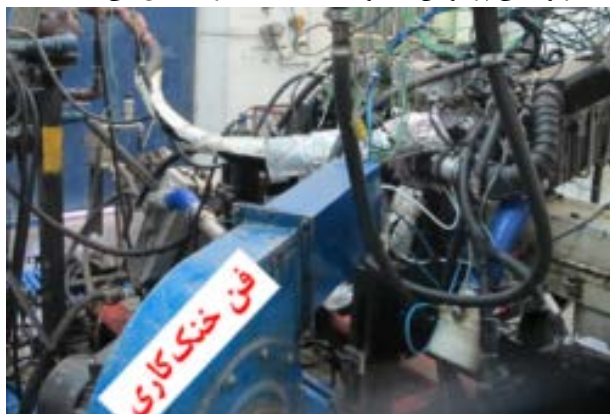
الف: موتور و فن خنک کاری
