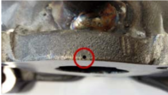
الف. چندراهه دود سوراخکاری شده برای نصب حسگر دما TFM1
