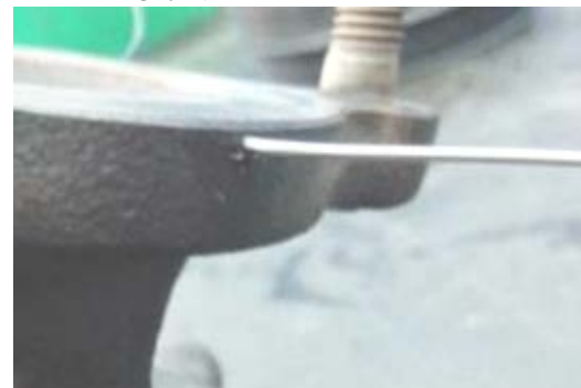
ب. حسگر دمای نصب شده بر روی محفظه دود پرخوران
