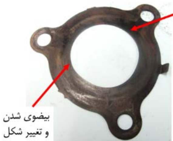
شکل ۲۲. تصویر لایه پرخوران در هنگام خرابی در آزمون دوام.
