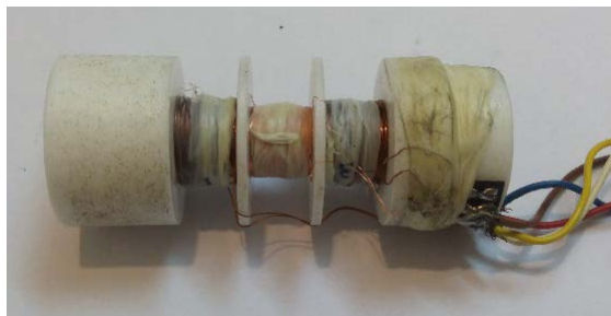
شکل ۴: نمونه ساخته شده حسگر شناسایی ذرات شماره دو
