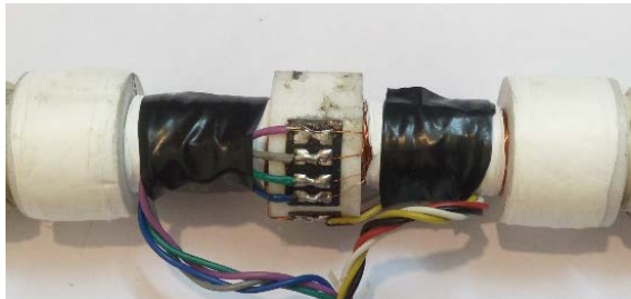
شکل ۳: نمونه ساخته شده حسگر شناسایی ذرات شماره یک
