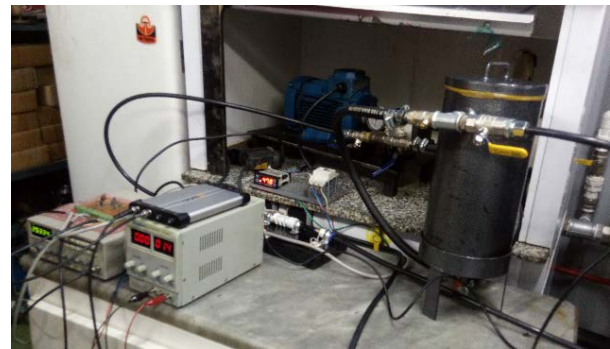
شکل ۵: مدار کامل ساخته شده برای آزمون روغن حسگرها
