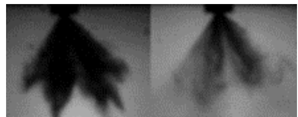
شکل ۸: تداخل و جدایی فواره های متفاوت افشانه در فشار پاشش سوخت ۵۰ بار و فشارهای محیط ۰,۰۵ بار (راست) و ۵ بار (چپ)
