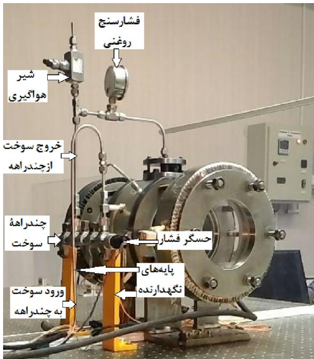
شکل ۳: محفظه و اتصالات آن از انباره تا افشانه
