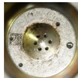
شکل ۲: تصویری از نحوه چینش سوراخ‌های افشانه
