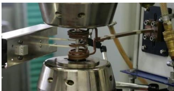
شکل ۲: تجهیزات مربوط به آزمون خستگی کم‌چرخه [۱۸]
