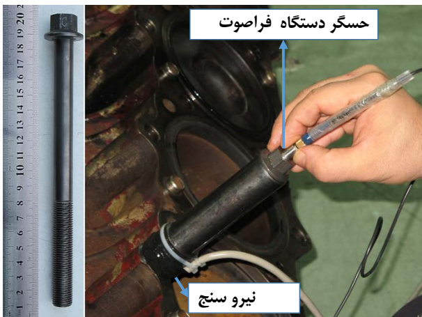
شکل ۴: اندازه‌گیری ز.ا.م. به همراه لائی نیروسنج
