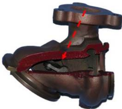
شکل ۱۶. نمای برش خورده محفظه گردا، خط چین عبور گازها را از مسیر دربیچه هدر رو را نمایش می‌دهد
