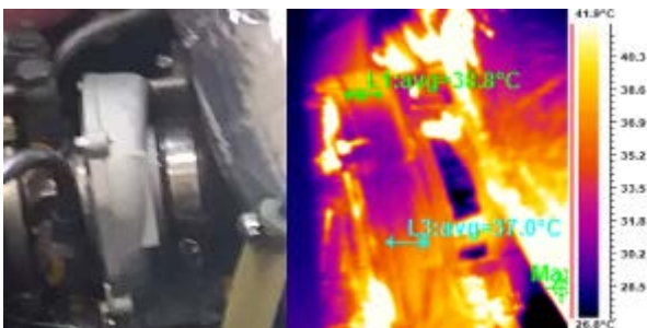
شکل ۱۷. محفظه تنجار در وضعیت پروانه خنک‌کن خاموش
