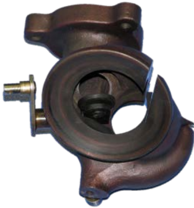
شکل ۱۵. نمای برش خورده محفظه گردا برای نمایش دربیچه هدر رو
