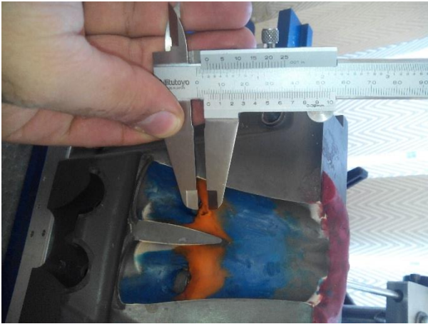
شکل ۳: انجام تغییرات بر روی جعبه جریان راهگاه پایه به جهت به دست آوردن هندسه بهینه (با استفاده از خمیر)
