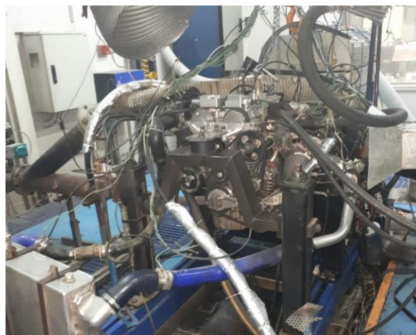
شکل ۳۰: نصب موتور ملی پرخوران در اتاق آزمون شرکت ایپکو
