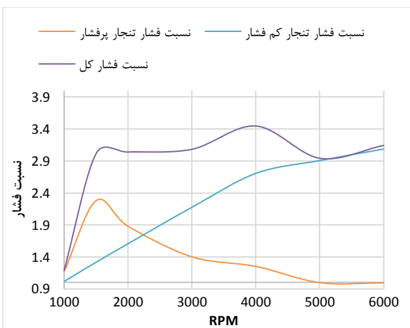
شکل ۵: نسبت فشارهای ایجاد شده در موتور پرخوران دوطبقه
