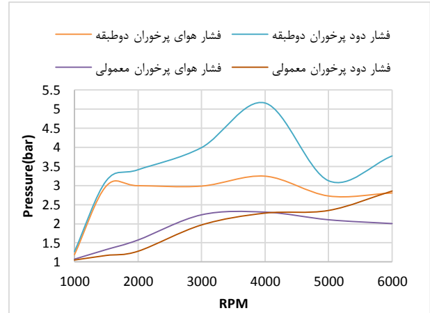
شکل ۶: مقایسه فشارهای هوا و دود در دو حالت پرخورانی
