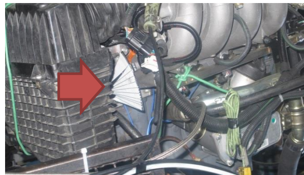
شکل ۵: نصب چندراهه هوا با صفحه چرخان روی موتور EF7 رای آزمون آزمایشگاهی
