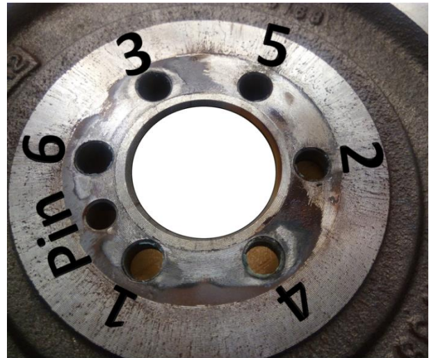
شکل ۱۸: آثار ساییدگی در سطح اتصال چرخ طیار به میل لنگ
