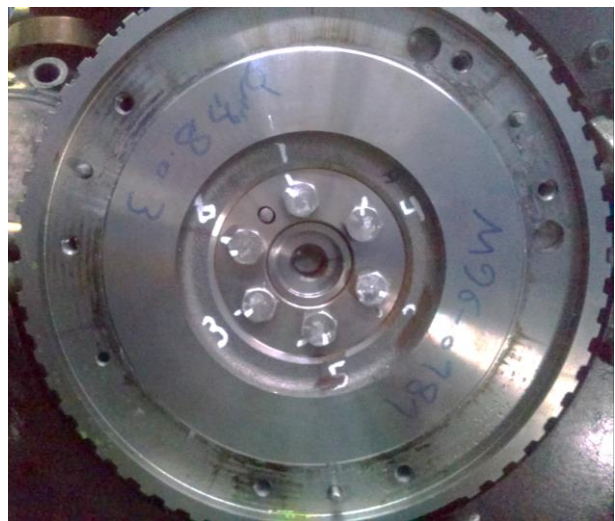
شکل ۲۰: چرخش پیچهای چرخ طیار پس از آزمون دور بحرانی سوم
