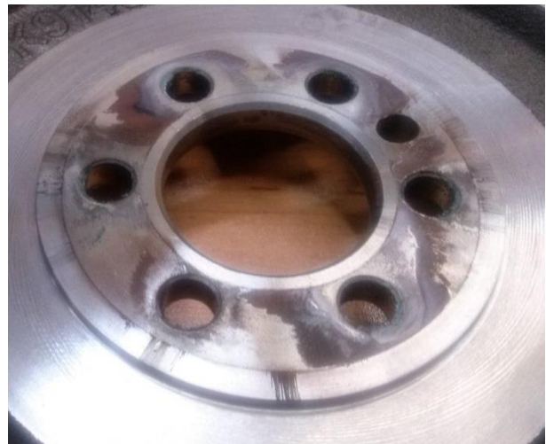
شکل ۲۱: آثار ساییدگی سطح چرخ طیار در اثر لغزش در آزمون سوم
