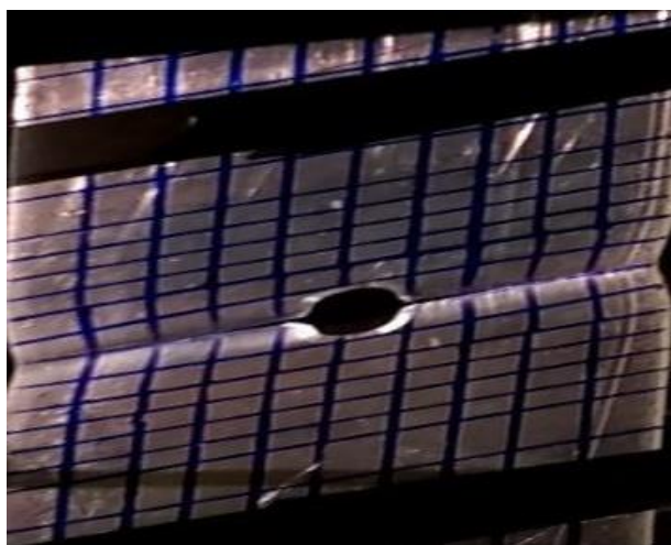
شکل ۹: رشد ترک در زمان ۱۲۰ ثانیه بعد از شروع آزمون کشش قطعه آلومینیومی
