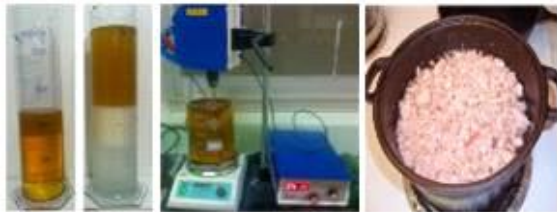
شکل ۲: مراحل تولید بیودیزل به روش ترانس استریفیکاسیون
