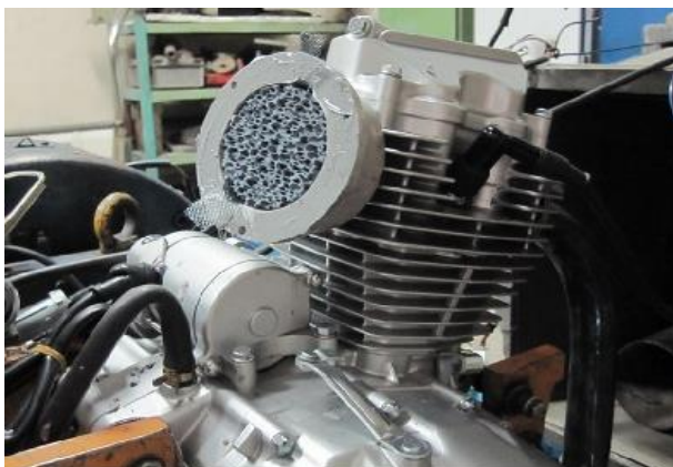
شکل ۶: تصویر آزمون موتور با دستگاه دینامومتر و محل قرارگیری محیط متخلخل
