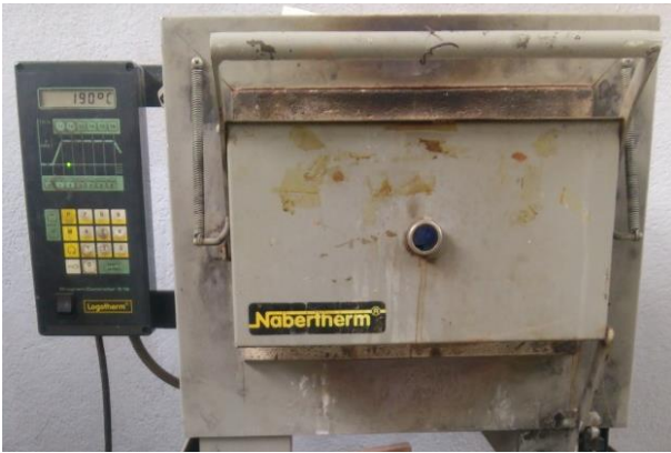
شکل ۲: کوره حرارتی به منظور اجرای فرایند عملیات حرارتی
