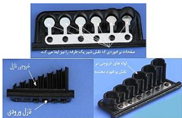
شکل ۱۰: جداساز برخوردی ماشین فوردد- اکوبوست
