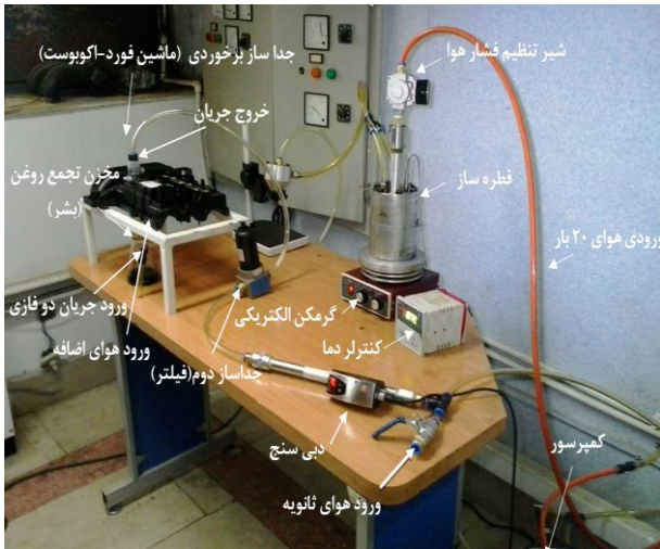
شکل ۶: چیدمان آزمایشگاهی جدا ساز برخوردی ماشین فورد-اکوبوست
