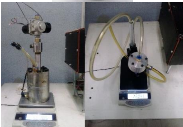
شکل ۱۲: وزن کردن تجهیزات آزمایش با ترازو با دقت \pm 0,1 \text{ mg}
