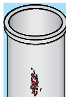
شکل 2: پدیده pitting ناشی از حفره‌زایی در سطح خارجی استوانه [6]
