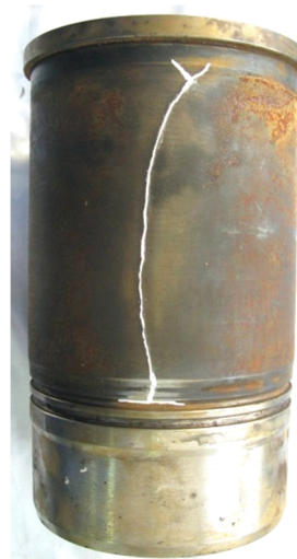
الف. ترک طولی (از رنگ برای وضوح ترک استفاده شده است)
