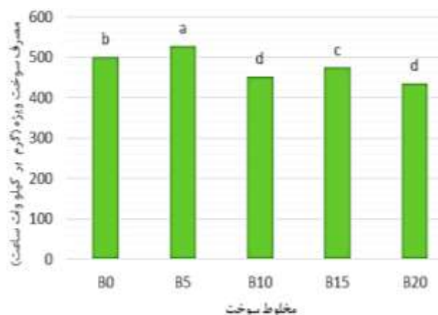
شکل ۵: تأثیر مخلوط سوخت روی مصرف سوخت ویژه موتور
