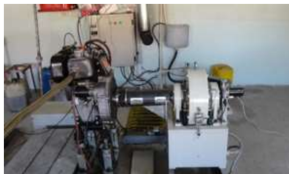
شکل ۲: نمایی از موتور و لگام ترمز مورد آزمایش
