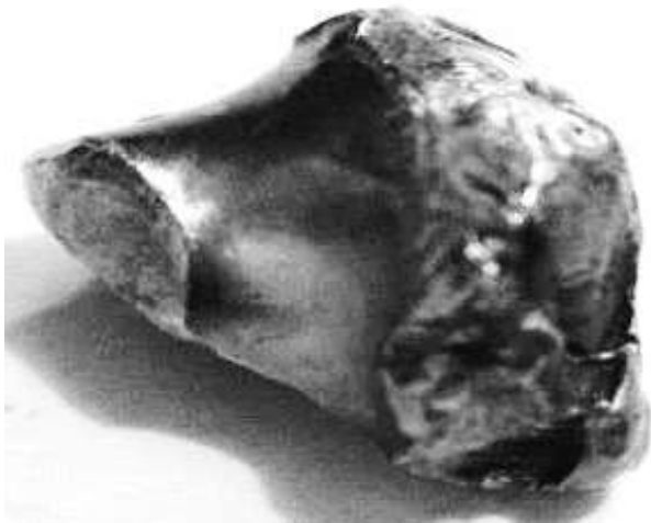
شکل ۵: قسمت ذوب شده کف دریچه
