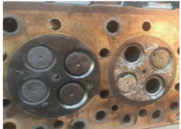
شکل ۳: قسمت تخریب شده در بستار
