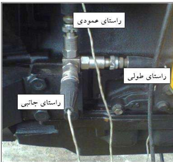
شکل ۳: نحوه اتصال شتاب‌سنج‌ها به موتور
