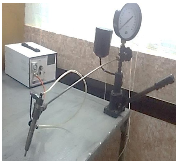
شکل ۷: دستگاه آزمون نحوه پاشش افشانه سوخت
